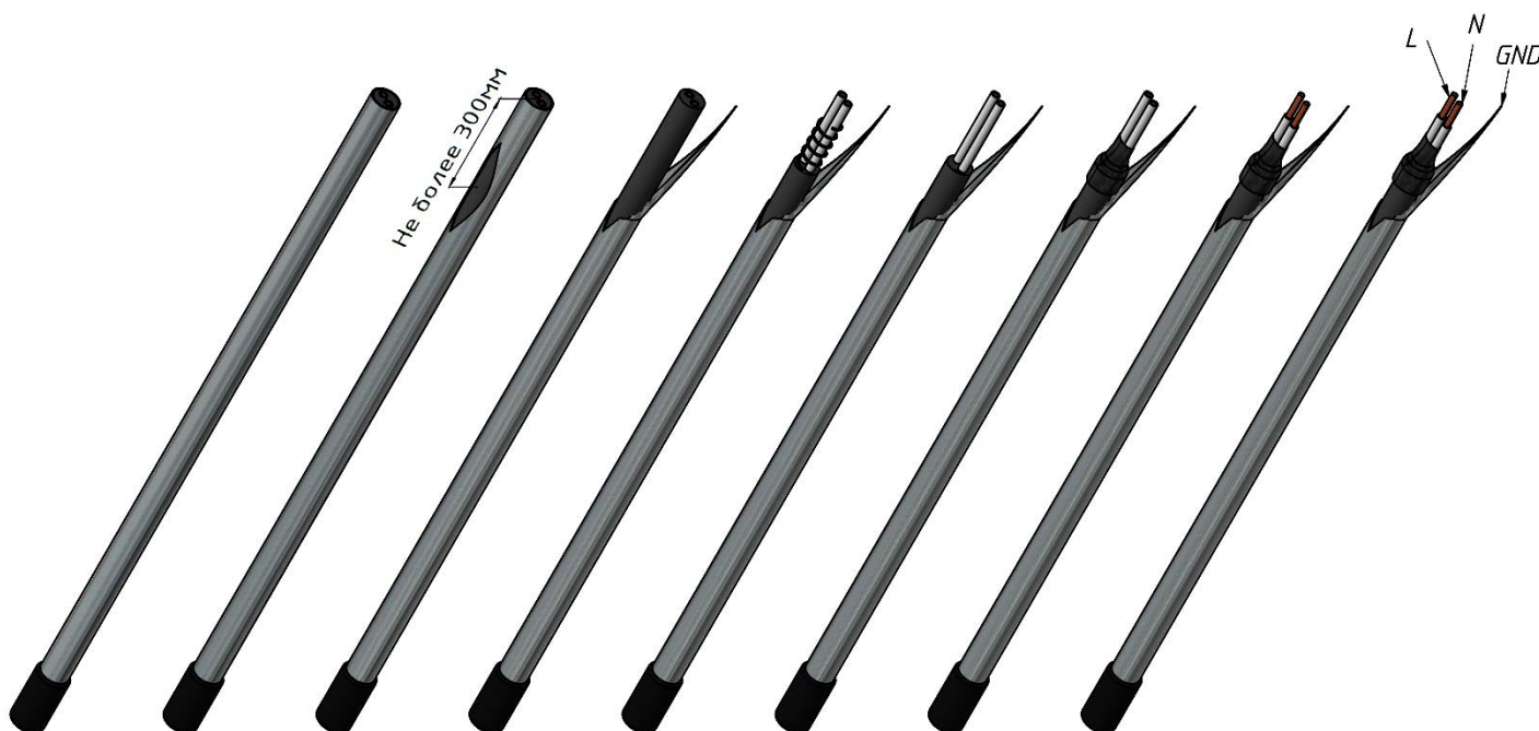
Рисунок 11. Подготовка отрезка ПЭНа к подключению
